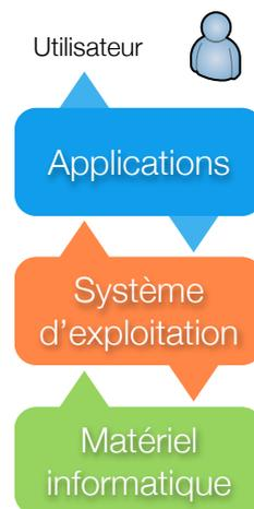
FIGURE 1.5 : Les applications tierces reposent sur le système d'exploitation. Le système d'exploitation offre une couche d'abstraction par rapport au matériel informatique sous-jacent.
